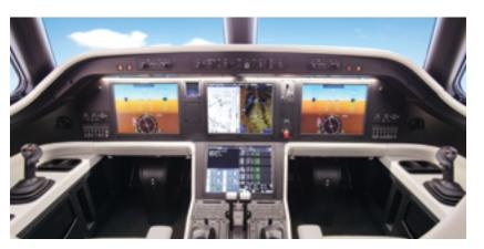
驾驶舱拥有电传操纵系统(唯一一架具 备此项性能的中型飞机)、一流的航电套 件和雷达, 雷达不仅能引导飞行员远离 恶劣气象条件,甚至还能安全穿越。
